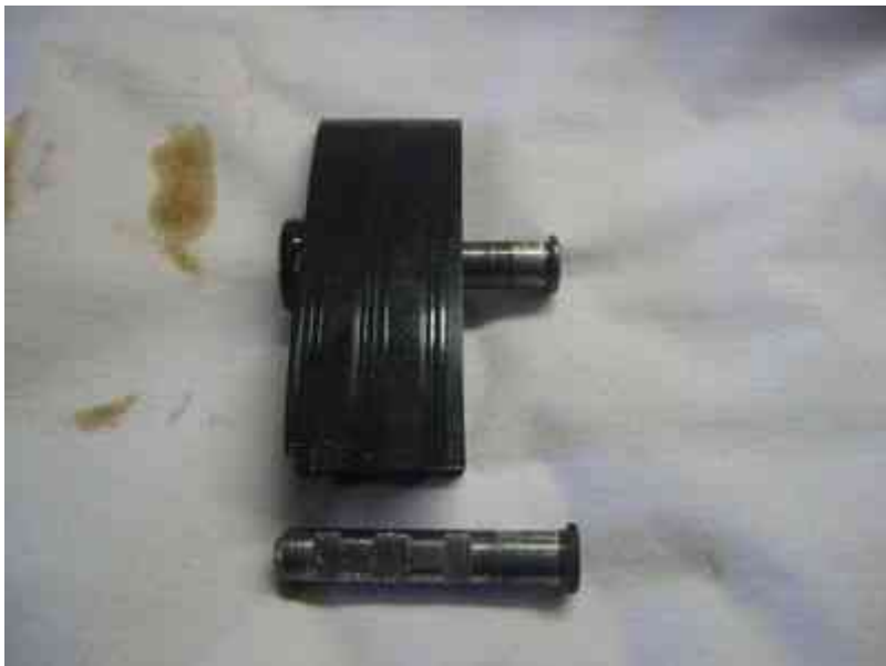
Abb.12 (alte Gleitschiene mit eingefrästen Bolzen)
