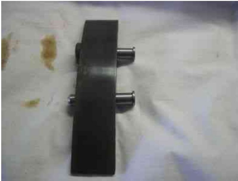
Abb. 13 (neue Gleitschiene mit neuen Bolzen)
