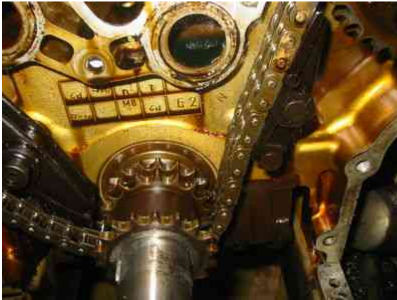
Abb. 17 (Gleitschiene „außen“ unten gebrochen)
